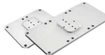
Aluminium Kombiplatte mit Schnappverbinder für zwei (Art.-Nr. 16110-2) oder drei (Art.-Nr. 16114-2) Hinweisschilder Form „A/B“ zum Verschrauben auf Abflachung des Pfostens. Auch zur Montage mit Spannband verfügbar. Aluminium combi-plate with snap-on connector for two (item no. 16110-2) or three signs (item no. 16114-2) of the form "A/B" to be installed with screws on flat top of post. Also available to be installed with tensioning strap.
